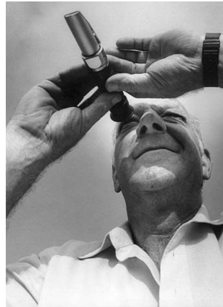
Mit dem Refraktometer misst Rebmeister René Gaschen die Oechslegrade.
