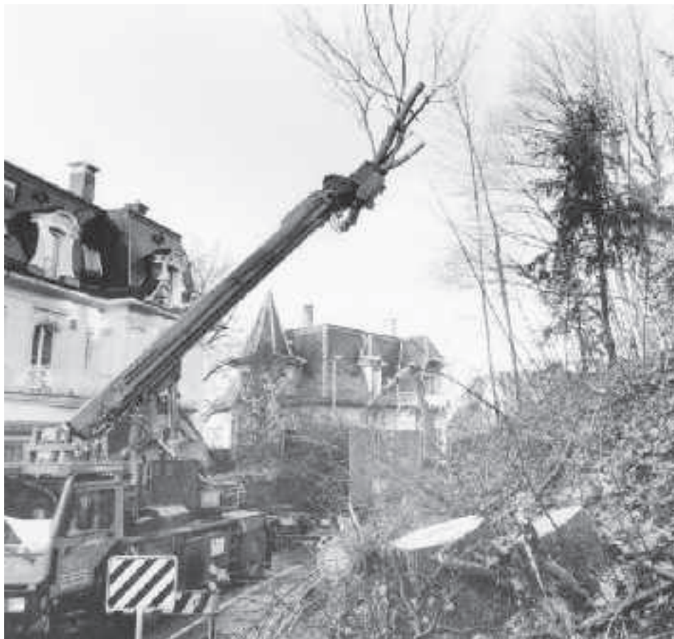
Beispiel für eine «Arbeit für Dritte» des Forstbetriebs: die Waldpflege beim Kursaal, bei der ein Fällkran die Bäume von der Schänzlihalde aus erfasste und direkt auf einen grossen Lastwagen verlud. (Fotos: Hansueli Trachsel)
