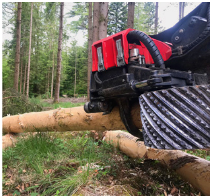
Forstvollernter entrindet vom Borkenkäfer befallene Baumstämme.
